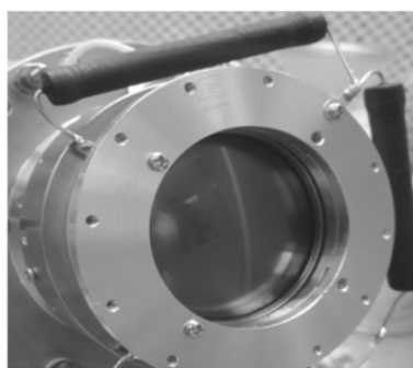
图 2 球面 MCP 光子计数成像探测器照片
