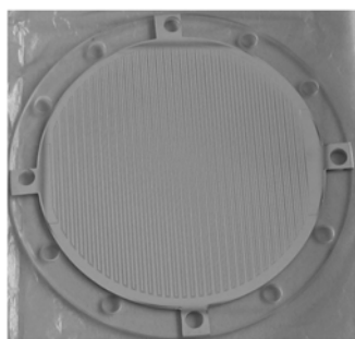
图 38 制备在石英基片上的 WSZ 阳极
