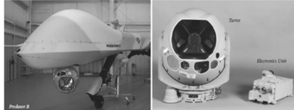
图 2 MTS-A/B 及其装机照片
