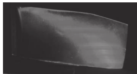
图 2 薄壁叶片表面光照现象
