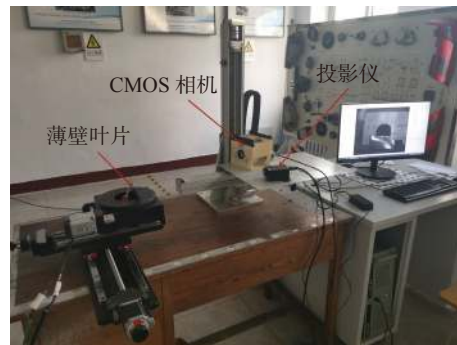
图 10 单目结构光检测实验场景
