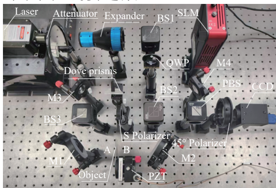
图 5 微位移测量系统实验装置
