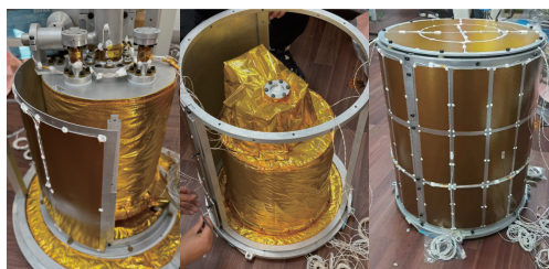
图 12 参考腔单元、恒温笼与隔离罩热实施照片
