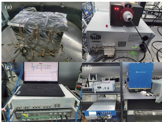
图4 实验系统实物图, A. 干涉仪光学平台; B. 自由运行激光器; C. 相位计(上)及控制器 Moku pro(下); D. 超稳激光器。
