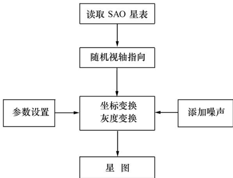
图2 星图模拟软件总流程图
