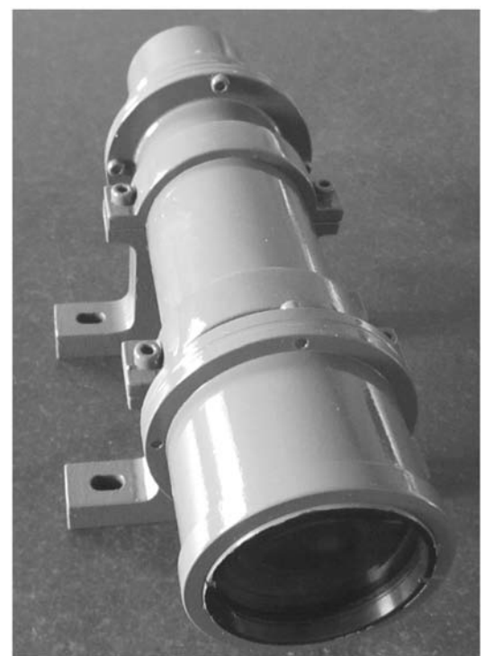
图 5 星模拟器平行光管
