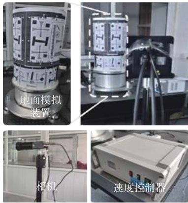
图7 模拟遥感图像获取装置
